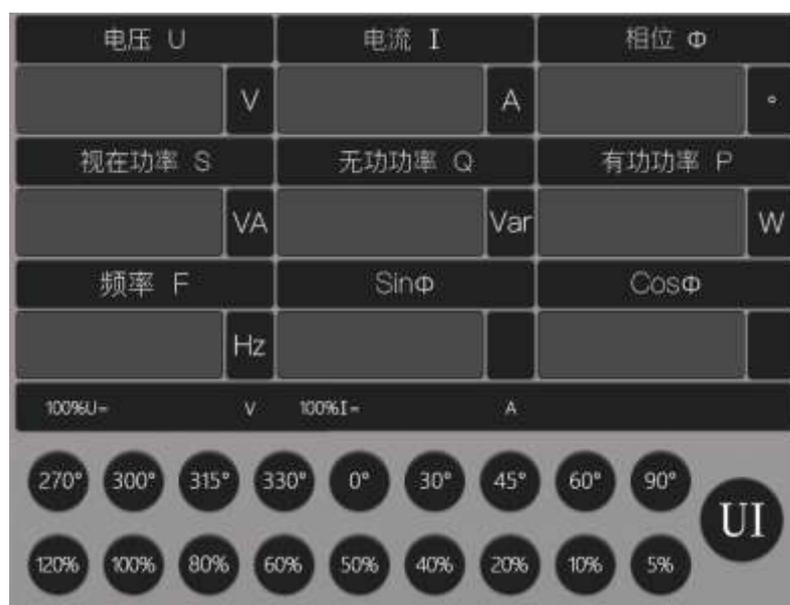
**2.1、界面布局说明。**在该界面里，上半部分可以实时显示电压 U、电流 I、相位 $\phi$ 、视在功率 S、无功功率 Q、有功功率 P、频率 F、无功功率因数  $\sin\phi$ 、有功功率因数  $\cos\phi$ 等 9 个参数。100%U 处显示的是当前的电压量程，100%I 处显示的是当前的电流量程，后面依次显示闭环开环状态，当前日期和时间。
