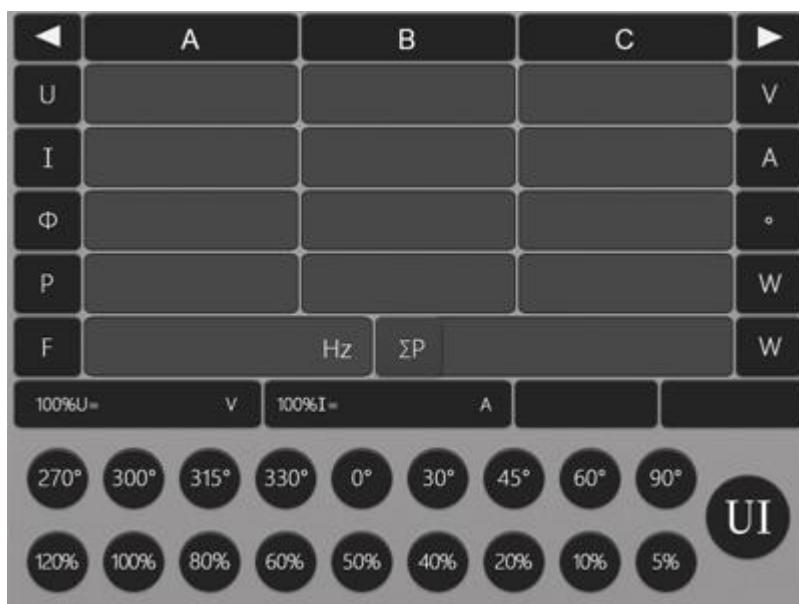
**2.1、界面布局说明。** 在电压电流显示界面里，上半部分可以实时显示三相电压 U、三相电流 I、功率相位  $\Phi$ 、三相有功功率 P 及总有功功率  $\Sigma P$ 、频率 F 等参数。100%U 处显示的是当前的电压量程，100%I 处显示的是当前的电流量程，后面依次显示接线方式，当前日期和时间。
