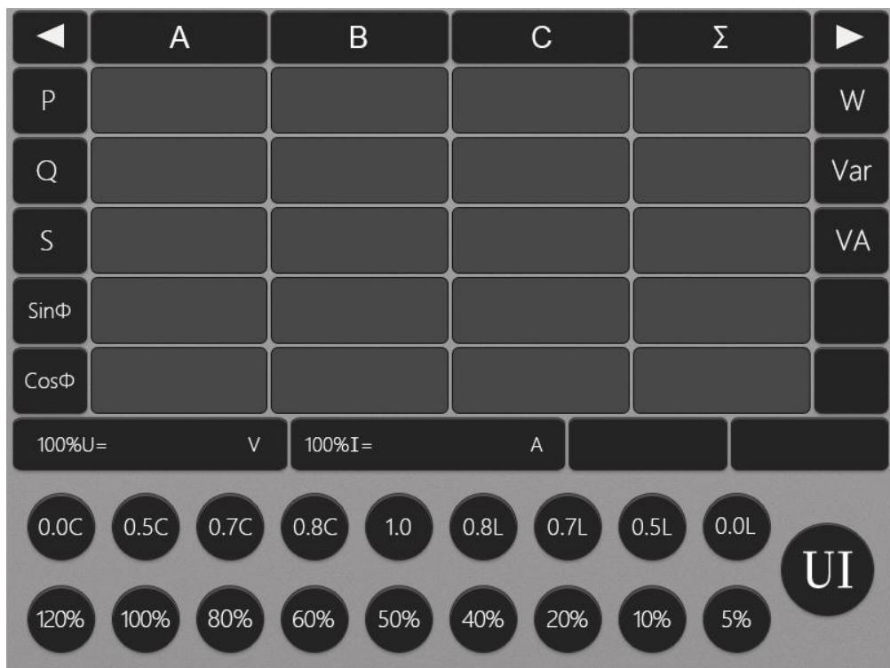
该界面里显示的参数有:三相有功功率 P 及总功率  $\Sigma P$ 、三相无功功率 Q 及总无功功率  $\Sigma Q$ 、三相视在功率 S 及总视在功率  $\Sigma S$ 、三相功率因数  $\sin\Phi$ 、三相有功功率因数  $\cos\Phi$ 。
