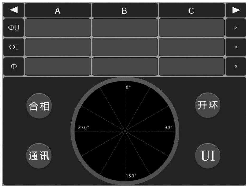
该界面上半部分显示的参数有：三相电压相位 $\Phi U$ 、三相电流相位 $\Phi I$ 、三相功率相位 $\Phi$ 。需要说明的是，A 相电压相位 $\Phi U_a$  永远是  $0^\circ$ ，不可调节，其它相的相位均是以 A 相电压为基准进行测量显示的。其它参数均可调节，具体调节方法参见第 2.4 项。
